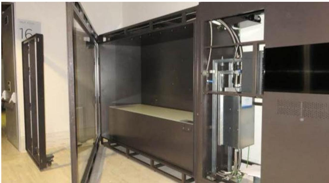
Figura. 2: La nueva vitrina estanca del MAN con sistema de filtración integrado.
